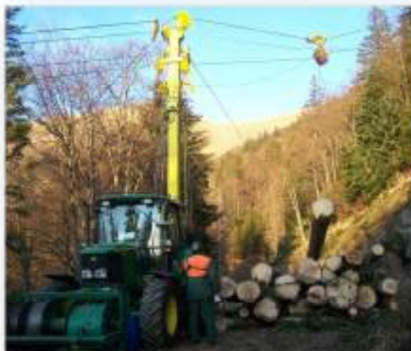
Figure 32 : Exploitation forestière par câble mât ( www.larix.fr )
